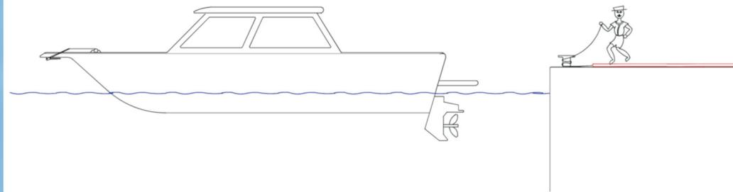
3. Mit den vorderen beiden Leinen den beschwerten Teil der Persenning unter dem Antrieb durchziehen
